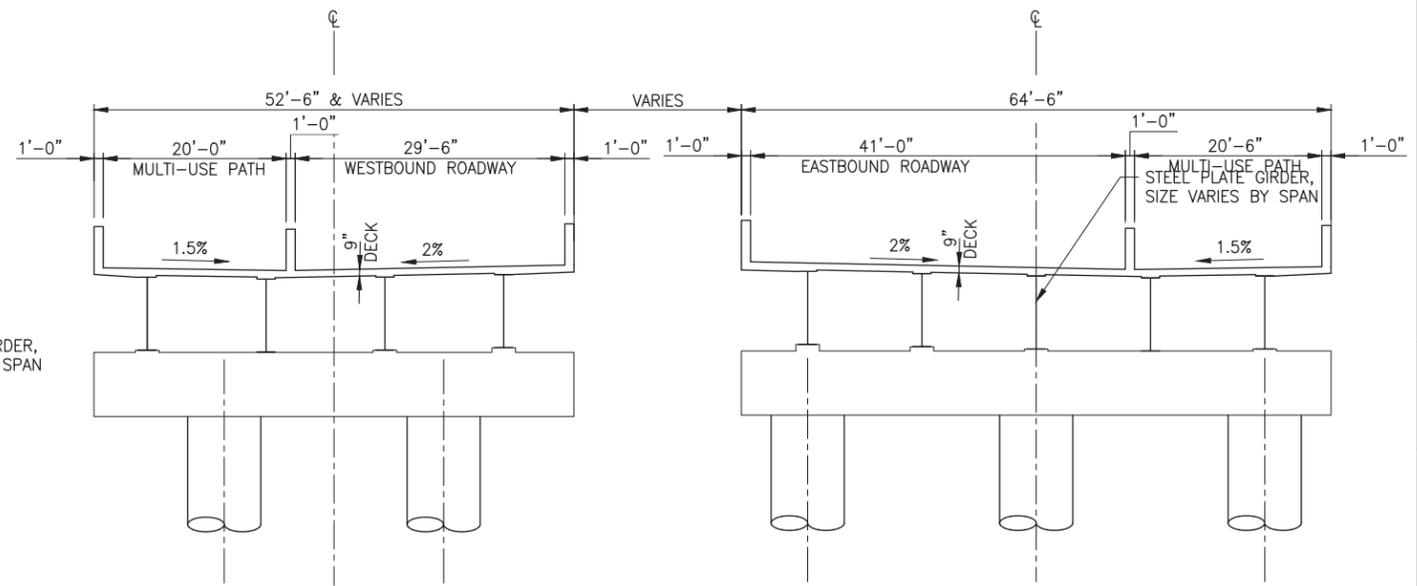
**COUPLER SECTION - STEEL PLATE GIRDER**
