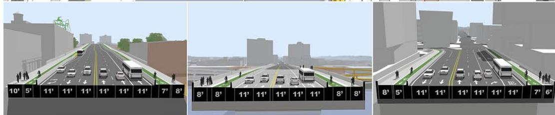
LANE CONFIGURATION AT WEST APPROACH      LANE CONFIGURATION AT MID-SPAN      LANE CONFIGURATION AT EAST APPROACH
